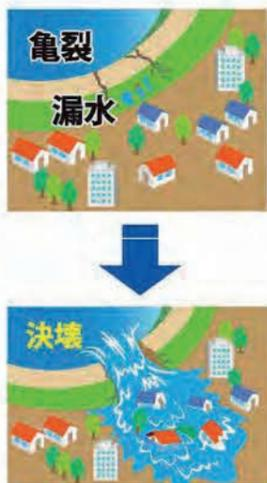
ため池は、大雨や大地震により、堤防に亀裂や漏水が発生すると、弱くなった堤防が貯水に耐え切れずに決壊します。
